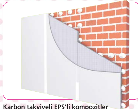
Karbon takviyeli EPS'li kompozitler Karbon takviyeli EPS ve ALLEV alçı levhadan oluşan kompozittir.
