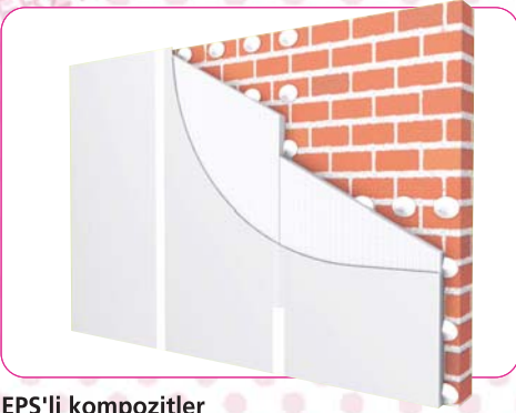
EPS'li kompozitler EPS (Genleştirilmiş polistren) ve ALLEV alçı levhadan oluşan kompozittir.
